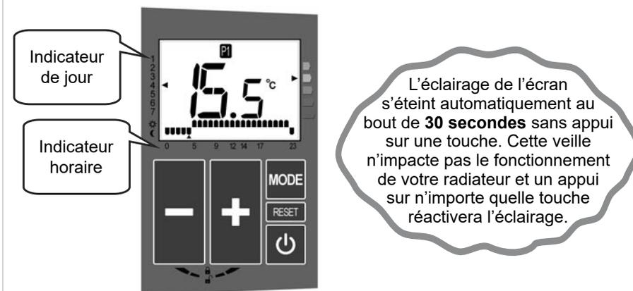
L'éclairage de l'écran s'éteint automatiquement au bout de **30 secondes** sans appui sur une touche. Cette veille n'impacte pas le fonctionnement de votre radiateur et un appui sur n'importe quelle touche réactivera l'éclairage.
