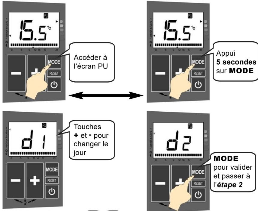
Il est nécessaire de **régler l'horloge** avant de configurer un programme utilisateur (voir **chapitre 6**).
