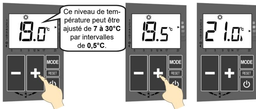
Ce niveau de température peut être ajusté de 7 à 30°C par intervalles de 0,5°C.
